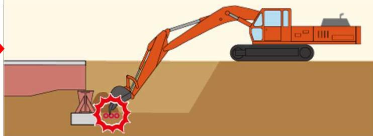
**【事故概要】** 仮橋の撤去作業中、橋台際に設置されていた大型土のうが支障となったため、元請職員が、近くで作業をしていた下請の作業員に、バックホウ（0.75m<sup>3</sup>級）で撤去するよう、指示した。
