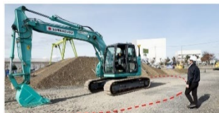
磁界検知範囲 (磁界検知ボックス接続台数と設定により検知範囲設定が可能)
