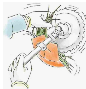
図 1.26 エンジンを停止して刈草の絡み付きを除去
