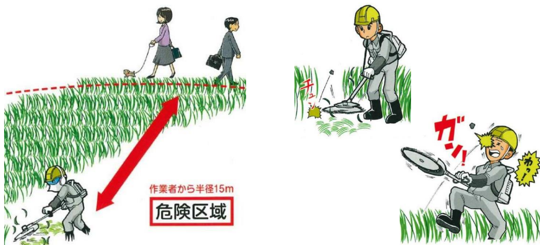
図 1.21 飛石の発生と作業者への衝突
