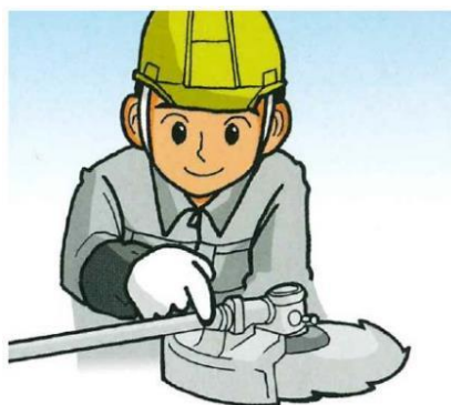
図 1.4 飛散防護カバーの確認
