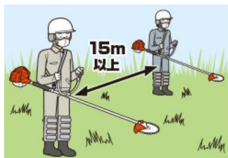
図 2.5 肩掛け式草刈機の離隔と法面での作業位置例（参考図）
