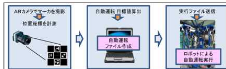
自動運転ステップ(ブロック把持・ブロック据付)
