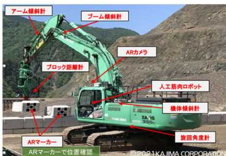
自動化施工仕様のバックホウ概要
