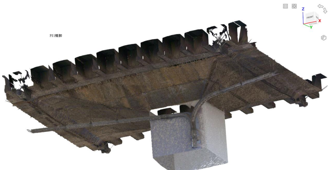
3Dスキャナーによる起工測量を実施し、 高精度の測量データを取得
