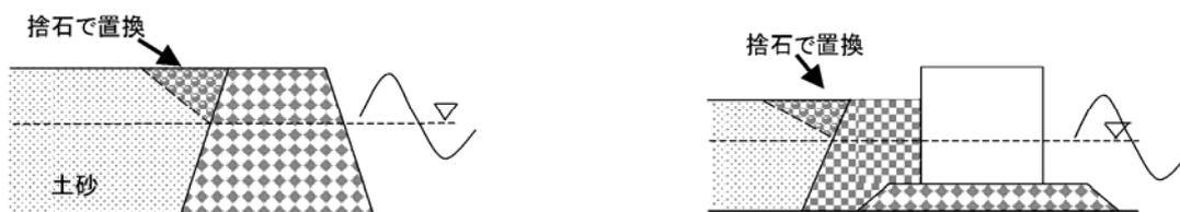
図 7-2-2 天端置換捨石による陥没孔防止対策
