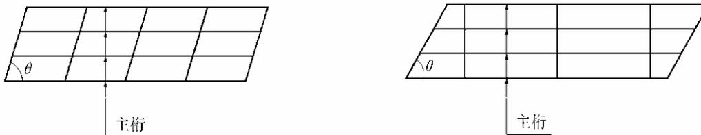
$90^\circ \geq \theta \geq 60^\circ$  斜角( $\theta$ )と同方向
