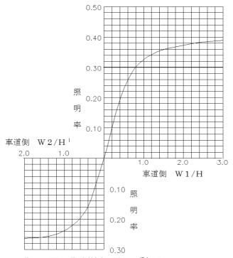
注)1. 服明率曲線は傾斜角度を5度とした場合を示す。 2. 適合最大ランプは蛍光水銀ランプ400W(HF400X)とする。
