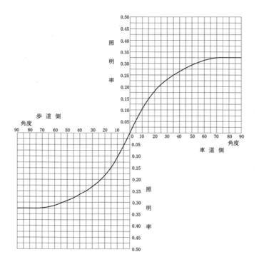
図4-3-6 側壁取り付け形照明器具(B形) 照明率曲線
