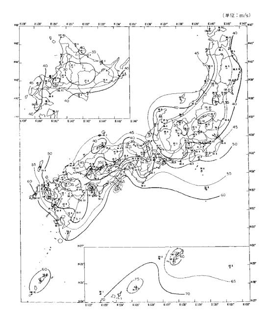
図2-5-6 再現期間50年の確率瞬間風速(m/s)分布図 (太陽光発電導入ガイドブック/NEDO)
