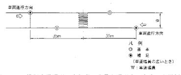
図 4-2-5 横断歩道照明 歩行者の背景を照明する方式の配置例表 4-2-3 横断歩道照明 歩行者の背景を照明する方式の配置例
