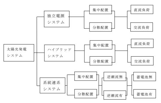
図2-5-1 太陽光発電システム分類図
