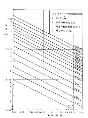
図 2-1-7 CVケーブルの短時間耐量
