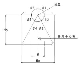
図8-1-5 照明率を求めるための角度の求め方
