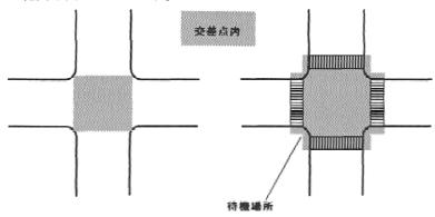
図 4-2-2(a) 交差点内の範囲 図 4-2-2(b) 横断歩道のある交差点内の範囲 交差点内の明るさは、次の値を確保する。
