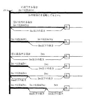
図 低圧幹線の過電流遮断器の施設
