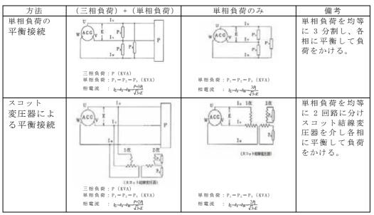
図 2-2-1 単相負荷の平衡接続(例)
