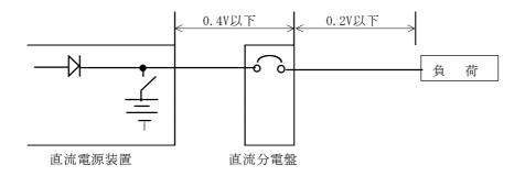
図 11-2-10 直流電源装置から負荷間の電圧降下配分
