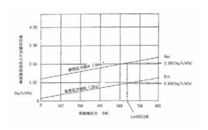
図 2-2-4 吸排気圧力損失の性能への影響
