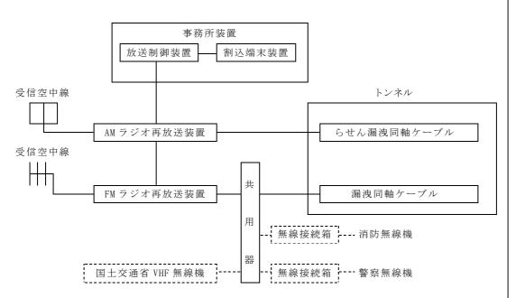
図 5-4-2 設備配置例 (AM ラジオのらせん漏洩同軸ケーブルによる送信)
