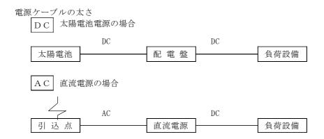
図 11-2-9 電源系統図
