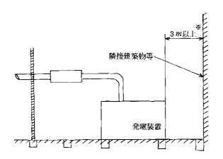
図 2-2-17 耐火構造建築物の屋上または地上に設備する場合
