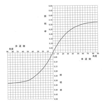
図4-3-4 側壁取り付け形照明器具(B形) 照明率曲線
