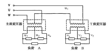
図 2-1-8 スコット結線変圧器
