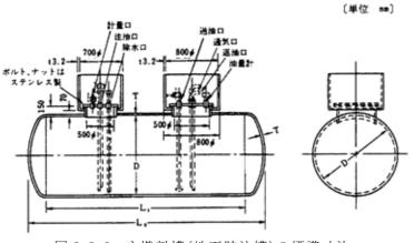
図 2-2-6 主燃料槽(地下貯油槽)の標準寸法
