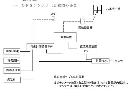
図 11-2-5 道路観測装置構成例
