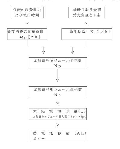
図2-5-2 独立電源システムの設計フローチャート
