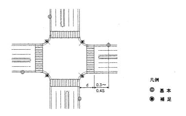
図 4-2-3 (b) 隅切り部への灯具の配置例
