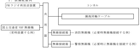
図5-3-1 トンネル片側坑口より無線供給する例
