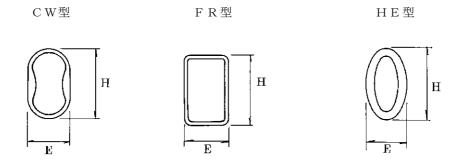
図 11-1-3 可とう導波管断面図
