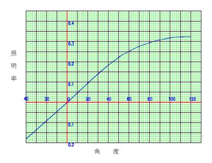
図 4-2-10 FL40 X 2 灯用照明率 (合成樹脂シリンダー、ガード付)
