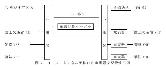
トンネル両坑口に共用器を配置したとき、両坑口無線機が同時送信する場合もある。 このため、相手側無線機に到達する電力が、無線機の許容される範囲まで落とすため に減衰器を挿入すること。
