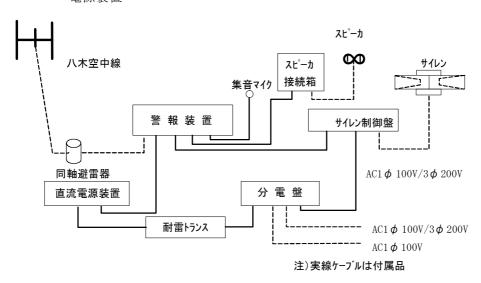
図 11-2-7 放流警報装置構成例
