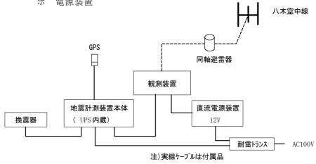
(参考)換震器は、地震センサと信号変換伝送器からなる。
