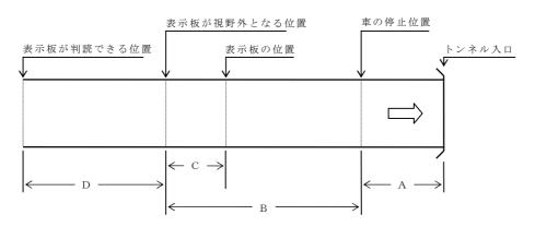
図5-1-2 トンネル坑口と警報表示板設置位置の関係
