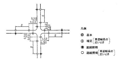
図 4-2-3 (a) 同程度の幅員を有する道路の十字路の灯具の配置例
