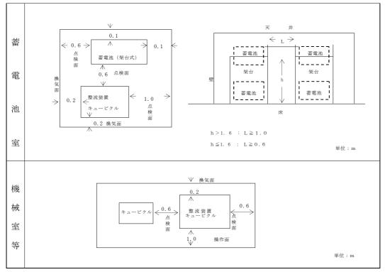
図 2-3-2 蓄電池設備の離隔距離
