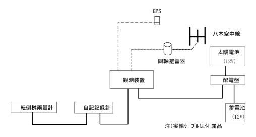
図11-2-2 雨量観測局装置構成例
