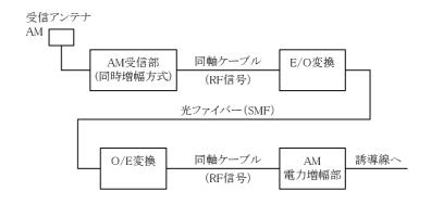
図 5-4-6 設備配置例 (同時増幅方式 分離受信)
