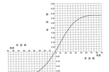
図4-3-7 取り付け形照明器具(BL形) 照明率曲線
