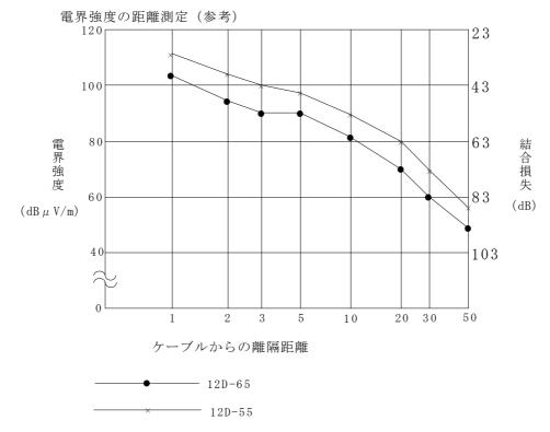
測定条件: 100m を地表に布設しほぼ中間点で測定 送信出力 1 W、1620kHz図 7-1-6
