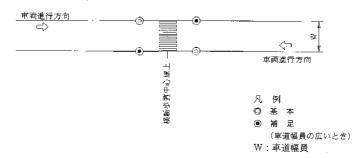
図 4-2-6 横断歩道照明 歩行者自身を照明する方式の配置例表 4-2-4 横断歩道照明 歩行者自身を照明する方式の配置例
