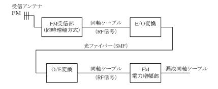
図5-4-9 設備配置例 (同時増幅方式 分離受信)
