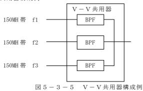
周波数が近接しているとき、バンドパスフィルター(BPF)が、複雑且つ挿入損失の増加、価格のアップになる。フィルターによる不要周波数の抑圧が十分出来ない場合には、他の無線機に混信を与え、また受けることになるので、設計の都度十分な検討を行うこと。
