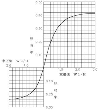
注)1、照明率曲線は飼料角度を5度とした場合を示す。 2、適合最大ランプは蛍光水銀ランプ400W(HF400×)とする。
