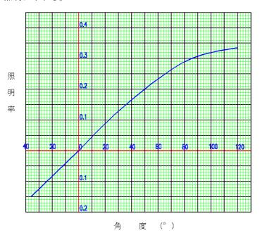
図4-2-9 FL20 (40) X1灯用照明率 (合成樹脂シリンダー、ガード付)
