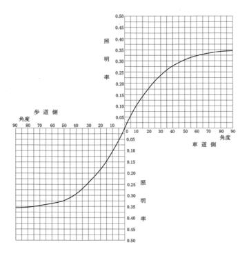
図4-3-5 側壁取り付け形照明器具(B形) 照明率曲線
