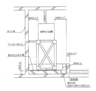
備考 防油堤に貯められる油量は、燃料小出槽の容量以上とする。 防油堤内側は、全面防水モルタル等で仕上げる。
