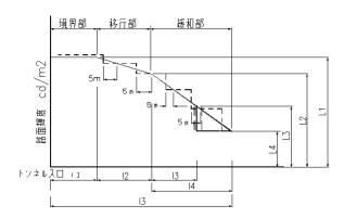
輝度はトンネルの奥に行くに 従って連続的に減少させてい くが、忠実に実施させる必要は なく、近似的に数段にわけて段 階的に行なう。この場合、前段 輝度の1/2以上になるよう にする。(点線部) なお、図の「5 m」は5 m以下 をいう。
