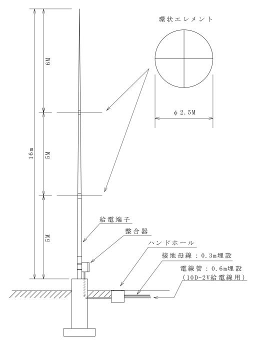
図7-1-7 基部絶縁形垂直空中線概要図
