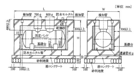
図 2-2-7 主燃料槽(地下貯油槽)の据付け標準図
