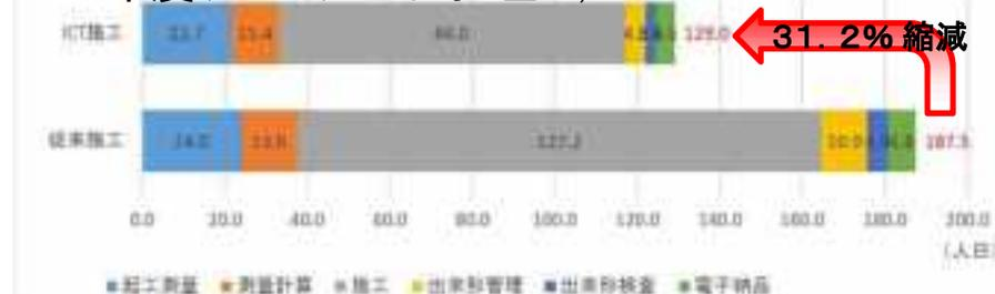
※測量計算：従来施工は横断面作成と丁張り計算、ICT施工は3Dデータ作成し起工測量結果と統合
