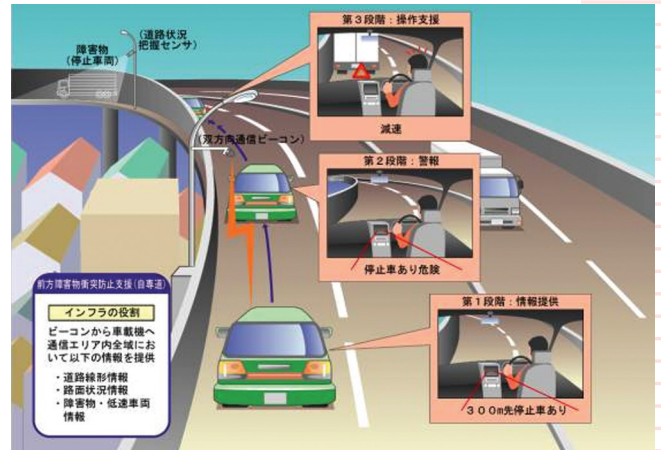
図 前方障害物衝突防止支援システム
