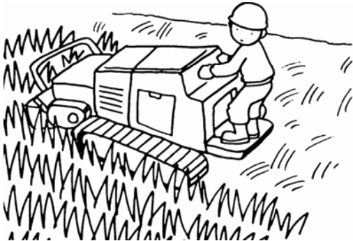
①異物を除去するため、飛び石防止装置を付けた機械で作業しているか ②事前に地形を確認しているか ③作業機械の転倒防止措置を講じているか
