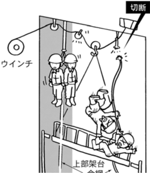
(2) 吊ワイヤロープ切断
