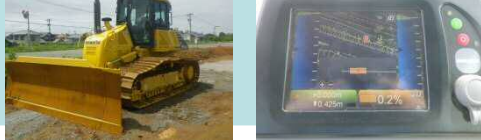
マシンコントロール（ブルドーザ）技術
