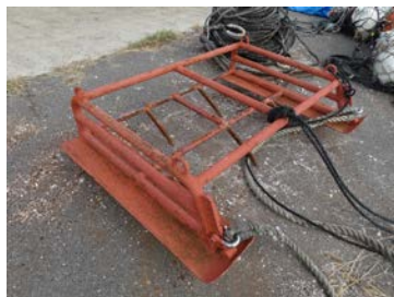
図 1-62 海底耕耘に用いる桁とその様子
