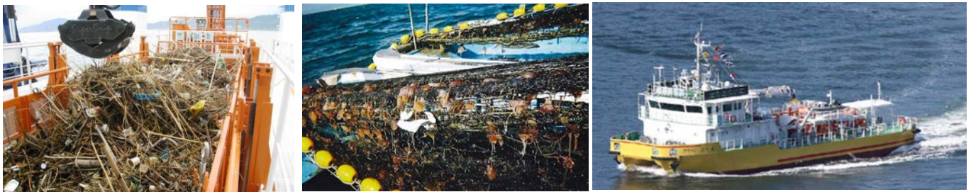
図 1-19 海面清掃兼油回収船による浮遊ごみ等の回収
