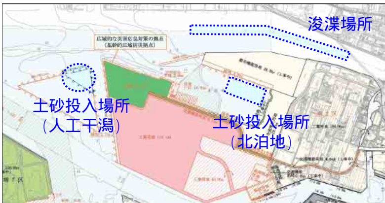
浚渫土砂の有効活用 (窪地修復等)
