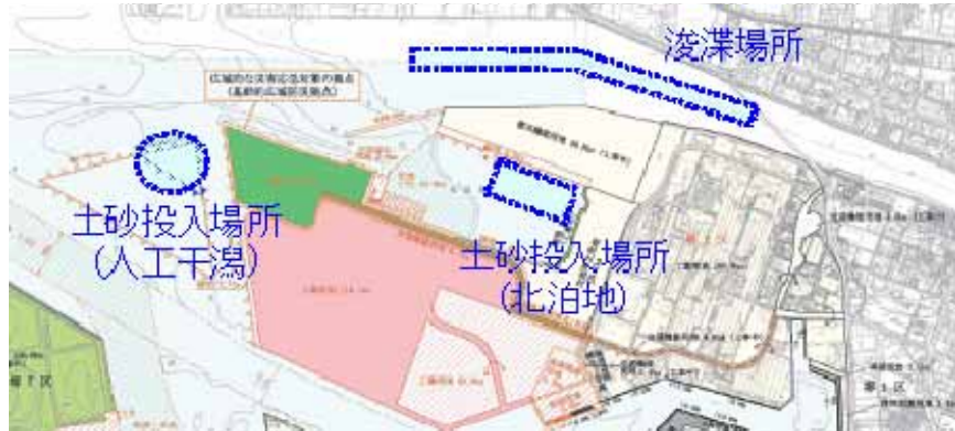
図 4-37 浚渫土砂の有効活用（窪地修復等）
