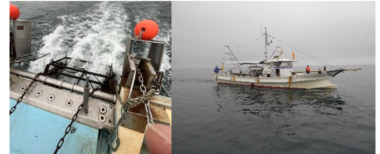
海底耕耘に用いる桁とその様子
