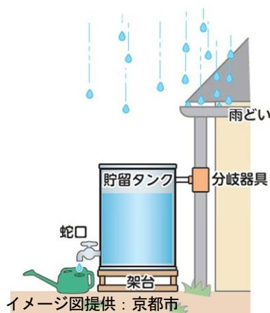
図 1-6 一般家庭等に設置する雨水貯留タンクのイメージ
