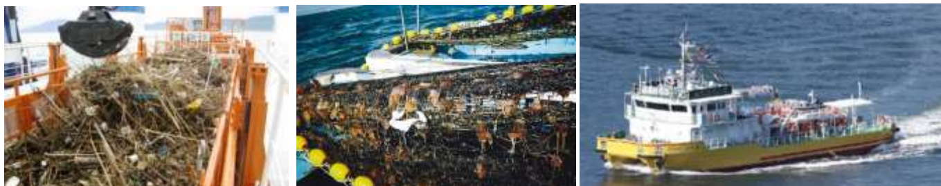
図 1-20 海面清掃兼油回収船による浮遊ごみ・油の回収
