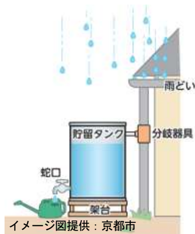
図 1-9 一般家庭等に設置する雨水貯留タンクのイメージ
