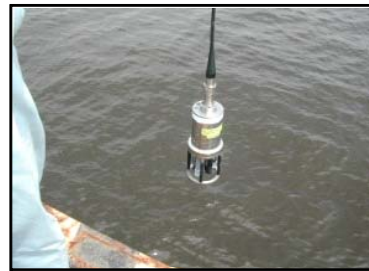
調査状況（多項目水質計）
