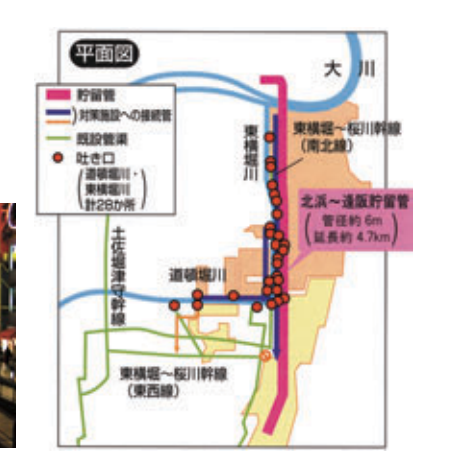
大阪市による合流式下水道改善事業
