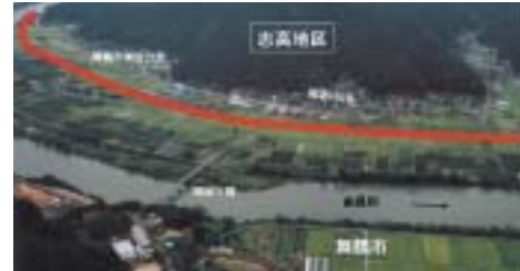
■由良川下流部輪中堤等により住家等を緊急的かつ効率的に浸水被害を防御。
