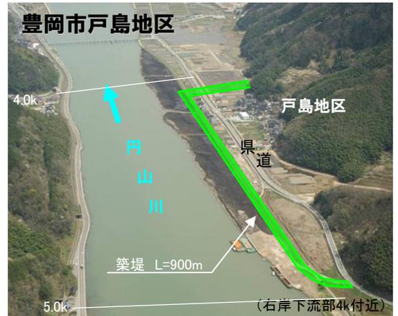
築堤(土堤)を行うことによりH21年洪水に対する浸水から防御
