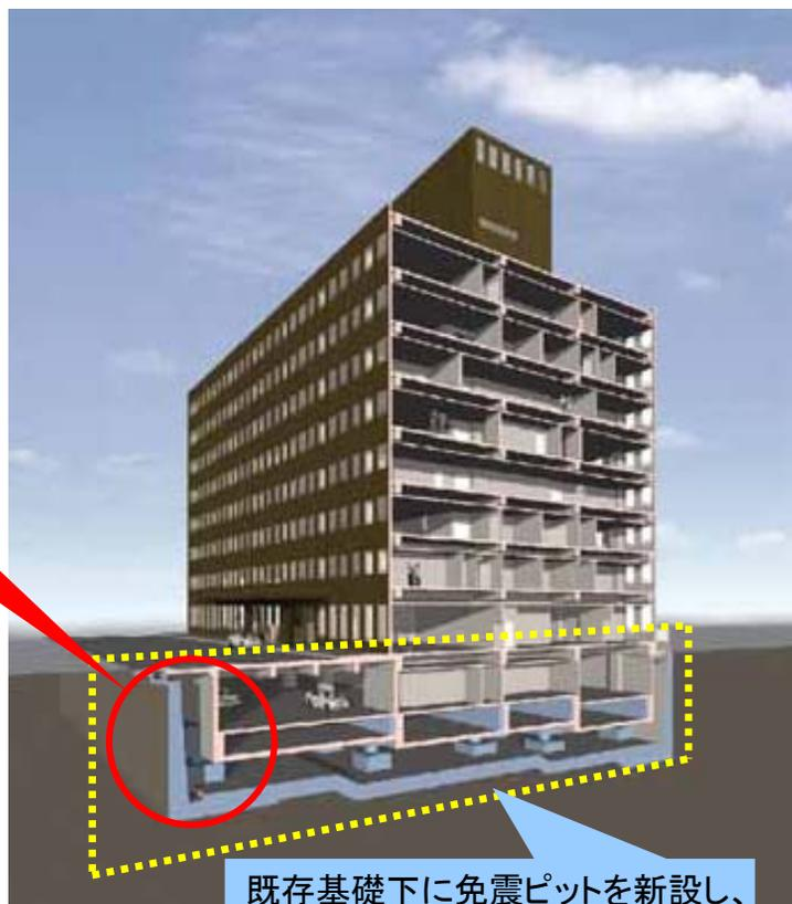
既存基礎下に免震ピットを新設し、免震装置を設置
