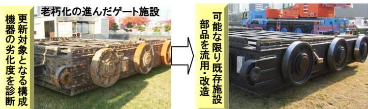
※消耗の激しい部材の材質を腐食に強いSUSIに変更することで、維持修繕に係るコストを縮減。
