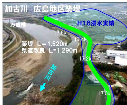
広島地区(小野市榎山町)は平成16年洪水(台風23号)において床上浸水15戸、床下17戸等の被害を受けています。平成23年度の完了に向けて築堤(無堤部解消)を推進します。(平成23年度完成予定)
