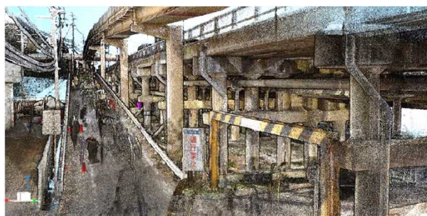
3次元レーザー測量による現況図
