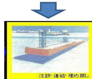
沈埋トンネル工法の施工手順
