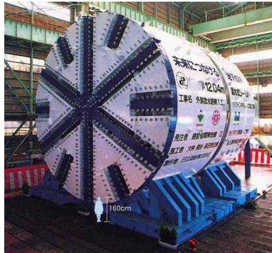
第1工区トンネル工事に使用した泥水加圧式シールド機の外観。シールド機は外径12.04メートル、長さ11.2メートル（写真：大林・熊谷・前田特定建設工事共同企業体）
