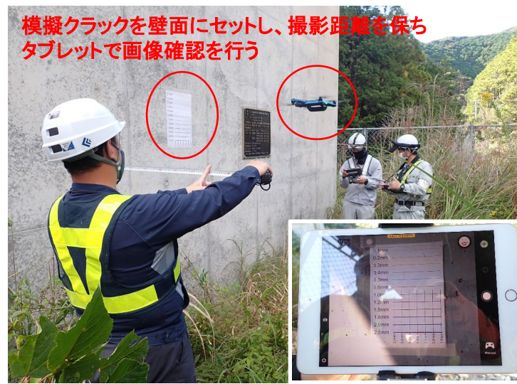
写真-2 キャリブレーション状況
