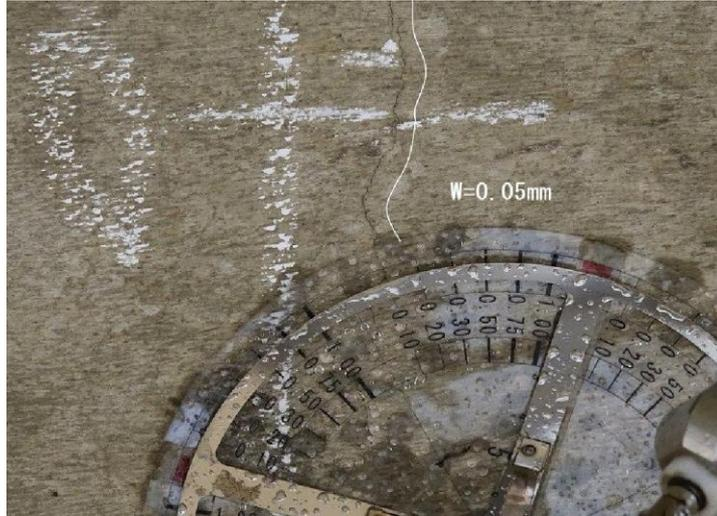
写真-1 クラックゲージによるひびわれ幅の測定状況
