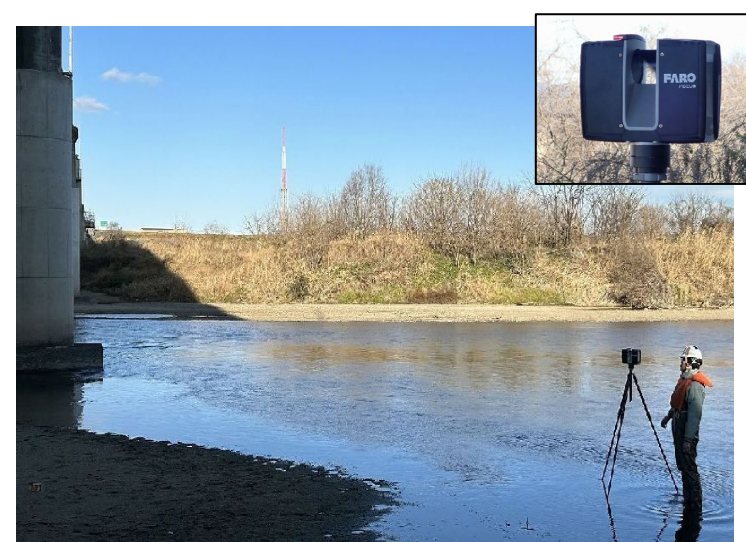
写真-2 計測状況(レーザースキャナ)
