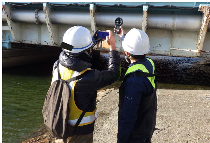
写真-2 風速確認状況
