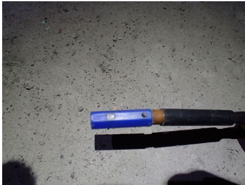
写真-3 プローブ(探傷装置)
