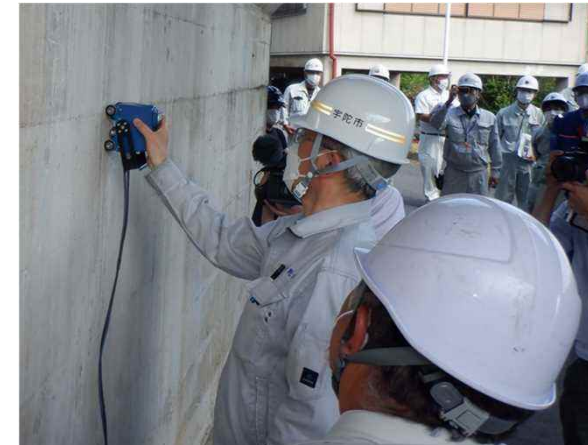
コンクリート構造物変状部検知システム「BLUE DOCTOR」
