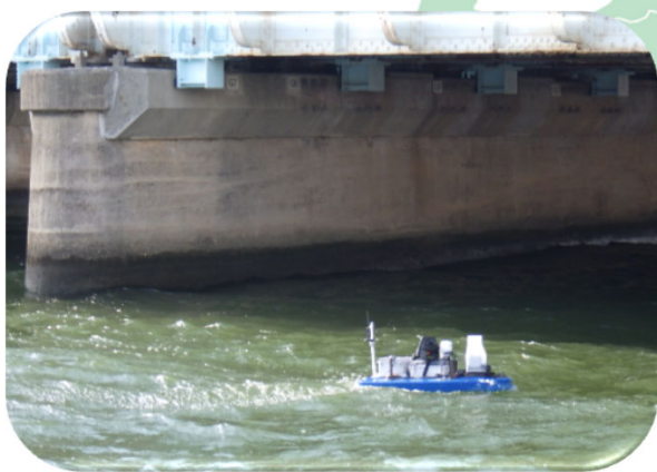
全方向水面移動式ボート型ドローンによる 洗掘状況の計測 国道2号淀川大橋(大阪府大阪市)
