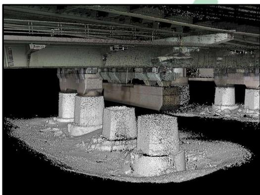
スキャニングソナーによる洗掘状況の計測
