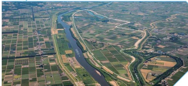
北村遊水地は、大きな洪水が発生した際に、石狩川の水を一時的に貯め込んで河川の水位を下げることで石狩川下流域に広がる市街地や農地を洪水による浸水被害から守る施設です。岩見沢市北村地区などで整備が進行中。遊水地内は優良農地であることから、平常時は農地などとして利用できるよう、地元の方々と様々な調整を行なながら進めています。
