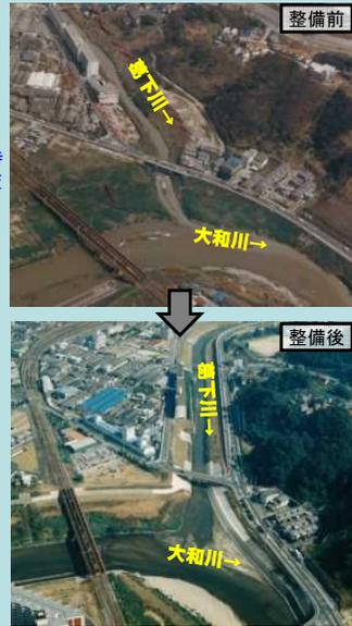
※昭和57年洪水と同規模の洪水のため、激特事業において実施した掘削及び築堤工事により氾濫すること無く、川の中で流下することができた。
