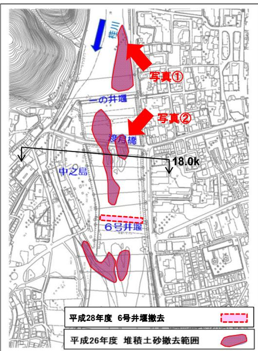
▲嵐山地区における堆積土砂撤去 (掘削量4,500m<sup>3</sup>)
