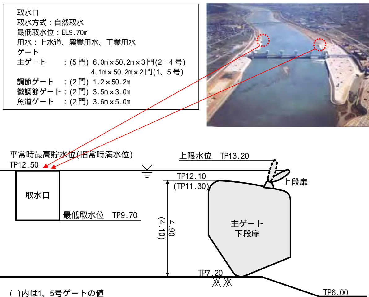
図 5.1-4 加古川大堰放流施設の概要
