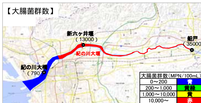
図 5.5-32 平成17年6月1日の水質縦断変化図
