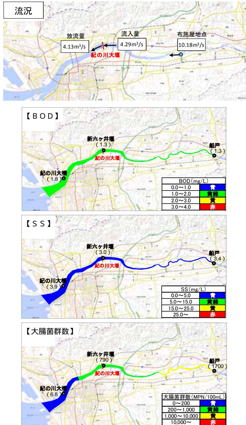
図 5.5-28 流況が悪い日の水質縦断変化図（平成16年1月7日）
