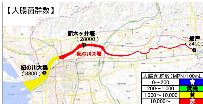
図 5.5-33 平成25年8月7日の水質縦断変化図
