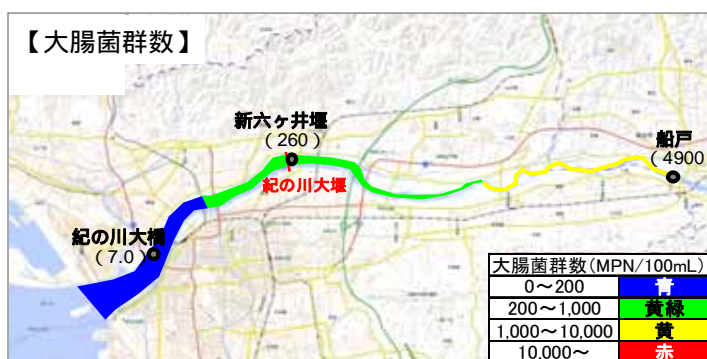
図 5.5-30 流況が悪い日の水質縦断変化図 (平成25年5月)
