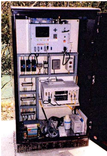
図 5.2-5(2) 大峰橋地点水質自動観測装置(操作盤・センサー部・立面図)
