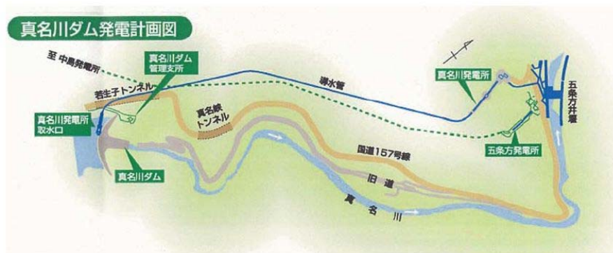
図 3.3-6 真名川ダム発電計画図（無水区間）
