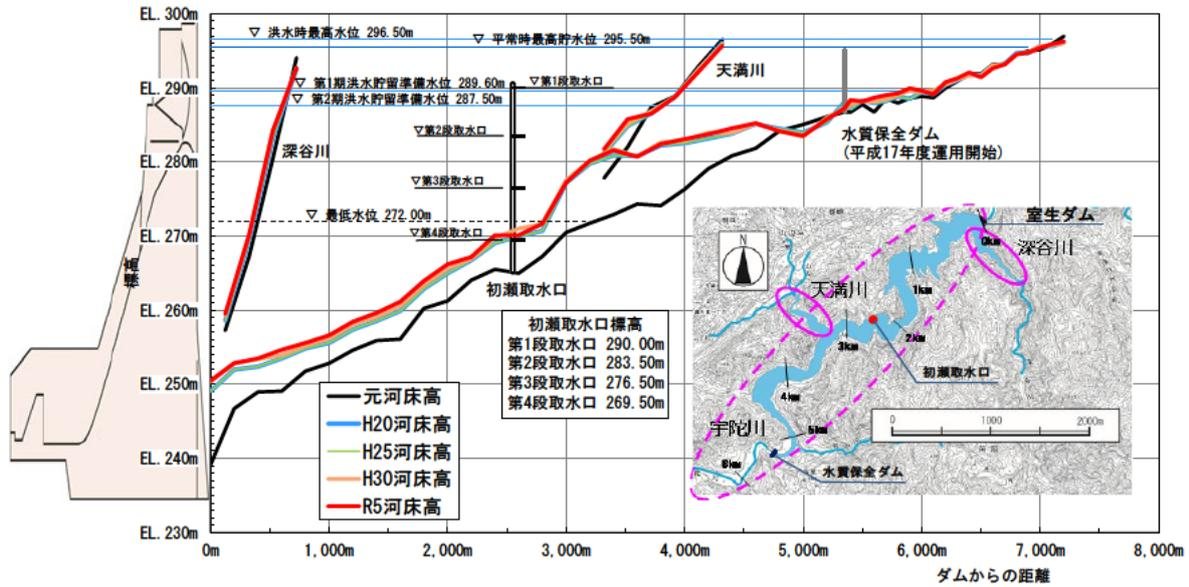
図 4.3-4 室生ダム 貯水池最深河床高縦断(堆砂縦断)の経年変化
