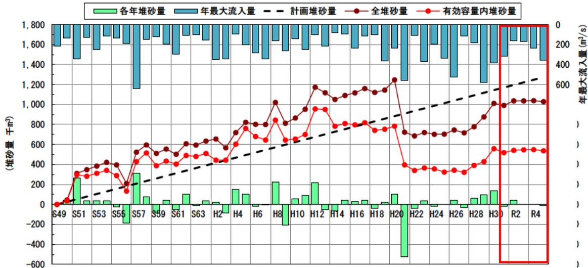
図 4.3-1 室生ダム 堆砂量経年変化
