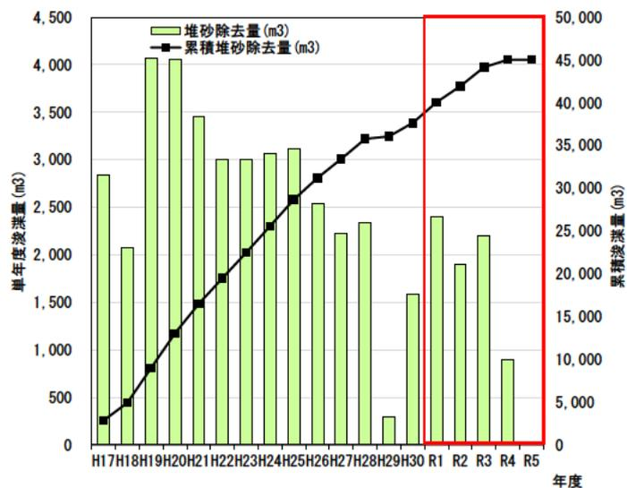
※1：平成29年の除去量が少ないのは、非洪水期の台風(10月22日)の防災操作により水質保全ダムの水位保持ゲートを倒伏したため、当該ダム上流で堆積していた土砂が室生ダム湖に流下し、除去できなかったことが要因である。
