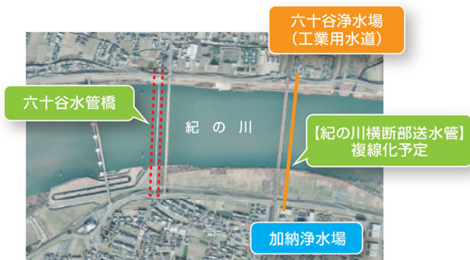
図 3.4-9 紀の川横断部における送水管の複線化イメージ
