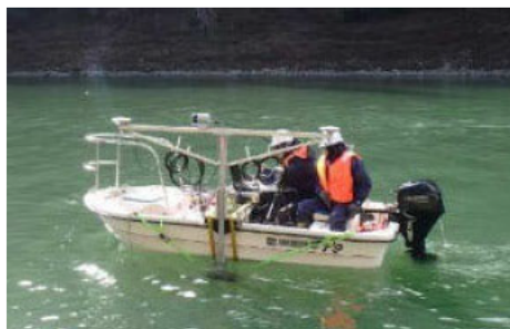
図 4.2-9 観測状況(左：測深作業、右：水中音速度計測)
