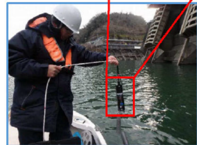
図 4.2-9 観測状況(左：測深作業、右：水中音速度計測)
