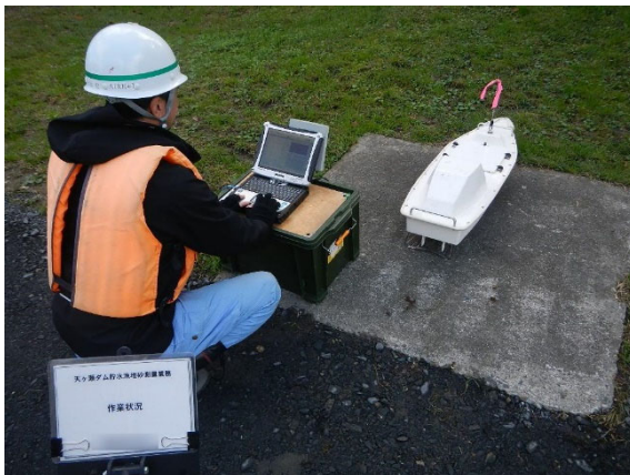
図 4.2-5 河川深淺測量実施状況
