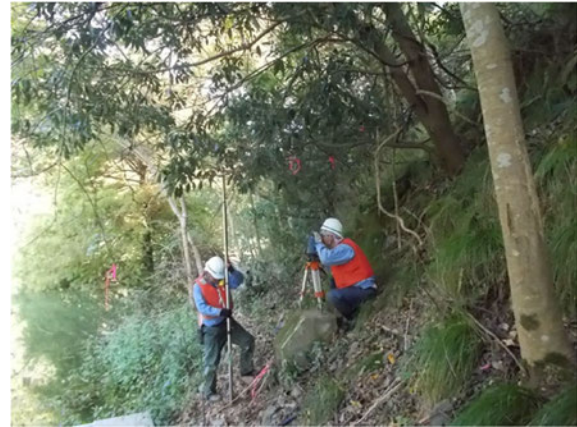
図 4.2-4 河川定期横断測量実施状況
