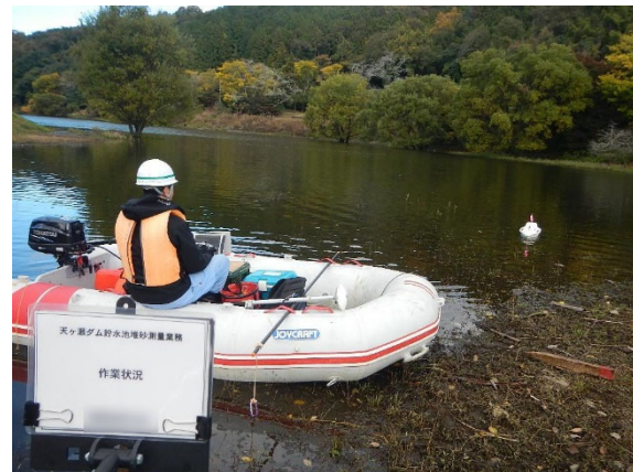
図 4.2-5 河川深淺測量実施状況
