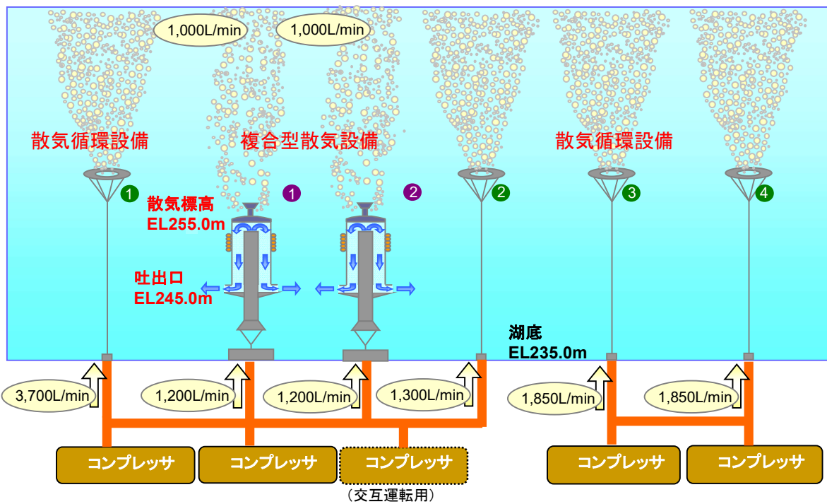
図 5.6.1-3 布目ダム水質保全施設(散気循環設備、複合型散気設備)の概要(現在)
