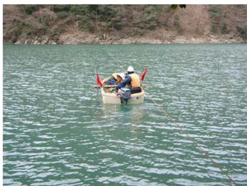
図 4.2-2 深浅測量作業状況
