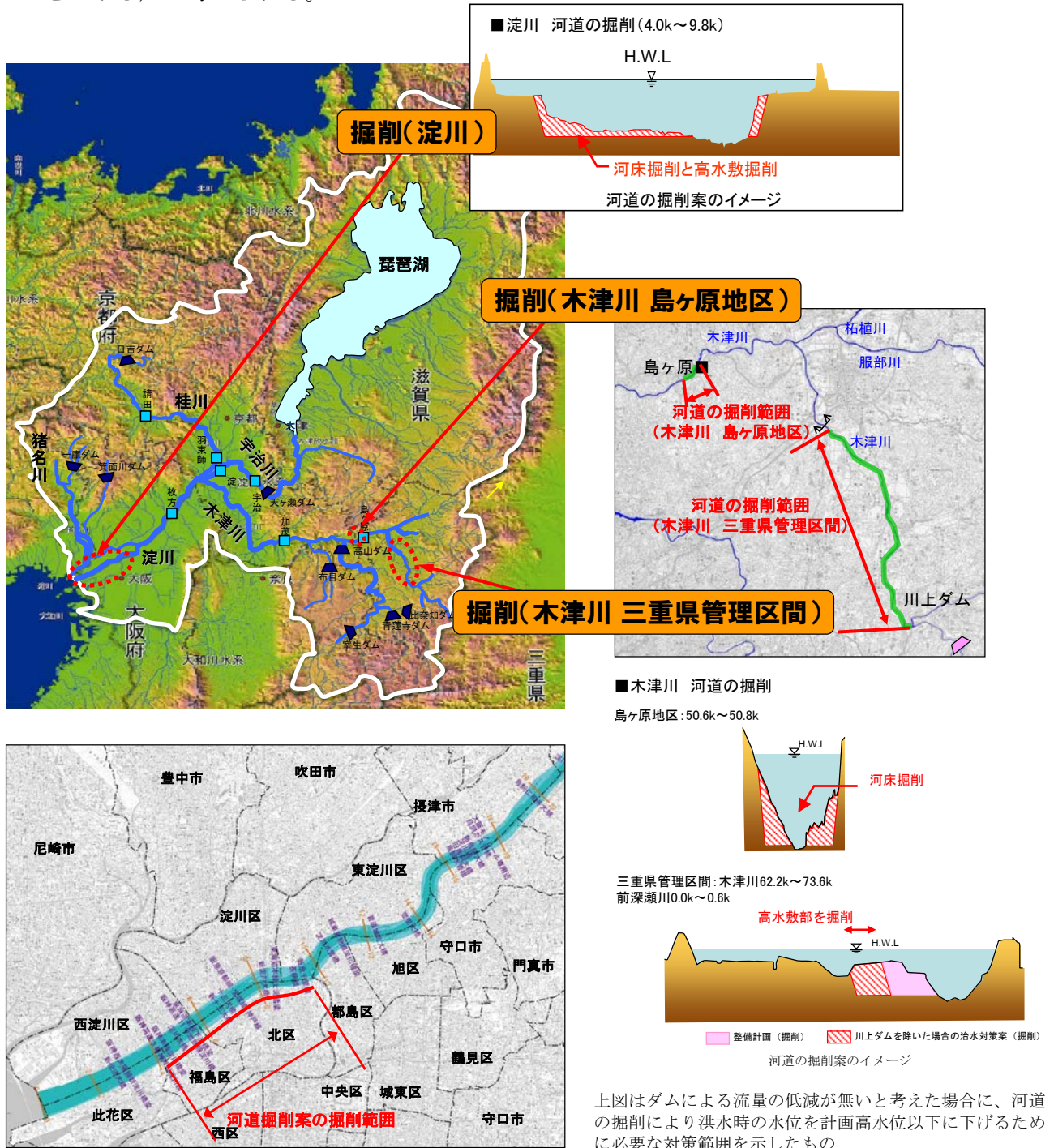
図 4.2-10 河道掘削区間位置図と掘削のイメージ図
