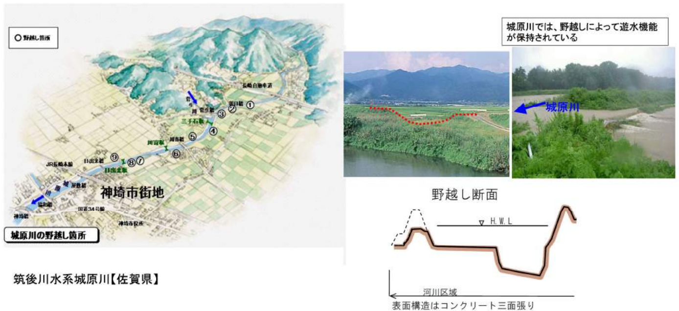
図 4.2-25 部分的に低い堤防の存置の候補地
