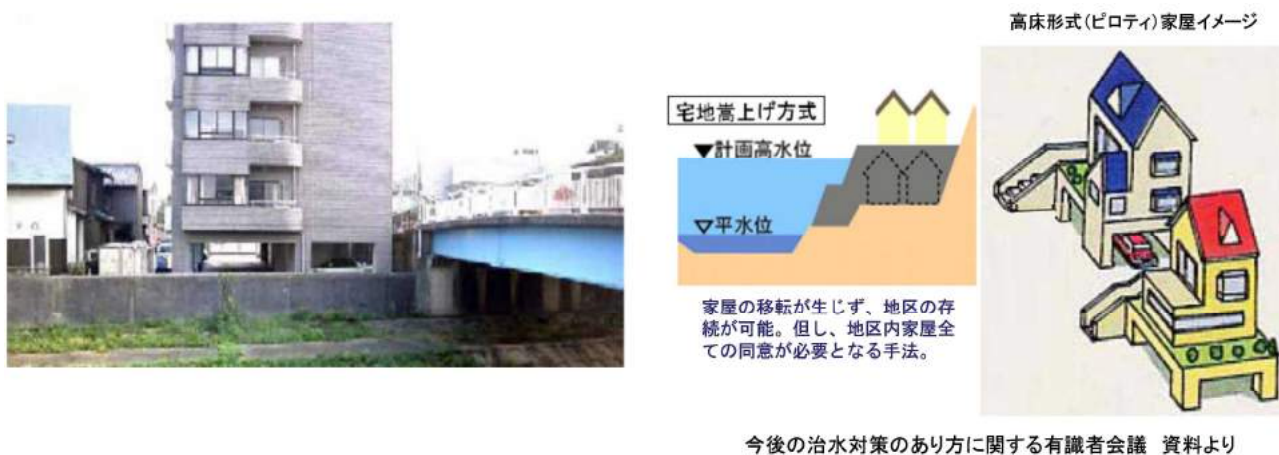
図 4.2-30 ピロティ構造の事例
