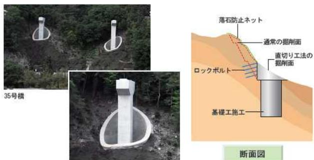
図 3.2-1 土地の改変面積を低減させた施工計画
