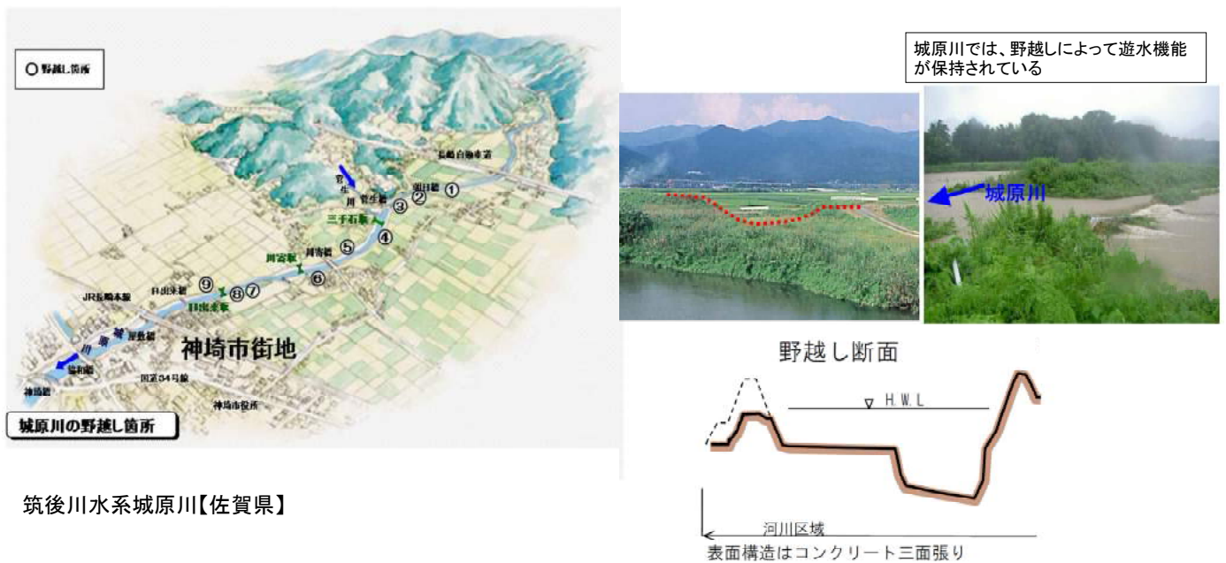
図 4.2-25 部分的に低い堤防の存置の候補地
