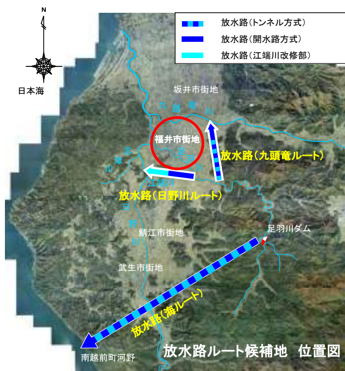
放水路(海ルート)イメージ (200m³/s規模のトンネル×3条)
